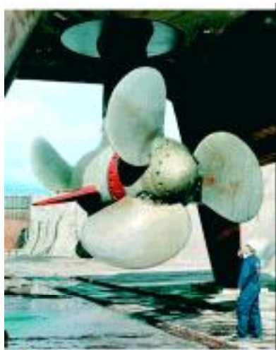
Fot. 6. Na współczesnych statkach coraz częściej pędniki azymutalne spełniają jednocześnie funkcję układu napędowego i maszyny sterowej, źródło: Ian C.
